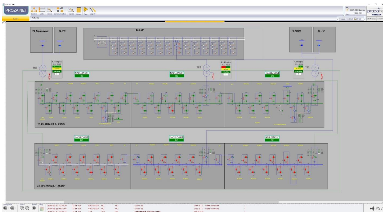
Slika 3. ProzaNet SCADA sustav u TS ELTO Zagreb – jednopolna shema
